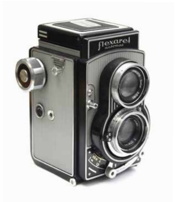
7. kép. A Barcsay család „Flexaret VI.” típusú kétlencsés, tükrereflexes fényképezőgépe (Leltári szám: III. 2008.2.1.)
